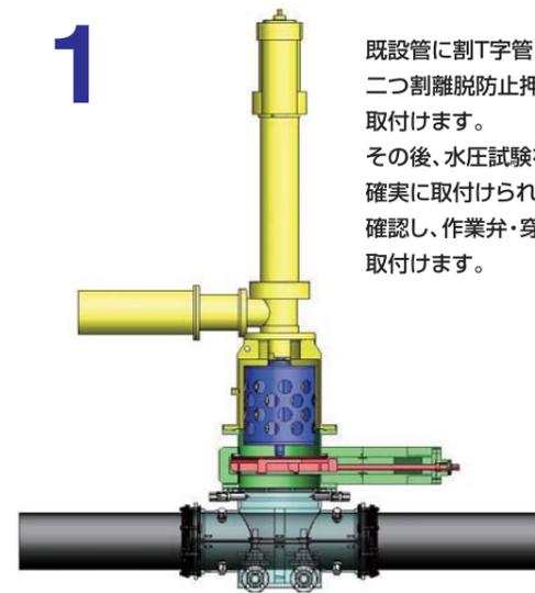
既設管に割T字管・二つ割離脱防止押輪を取付けます。その後、水圧試験を行い、確実に取付けられたことを確認し、作業弁・穿孔機を取付けます。
