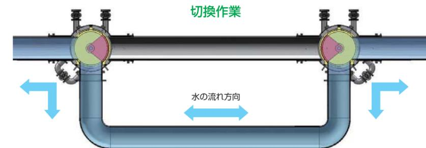
4 本管を切断し、管帽・管栓を取付けて切換完了です。
